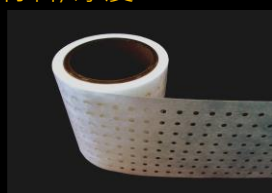
玻璃纤维片上打孔
