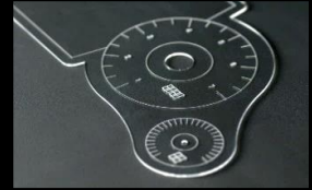
使用檢流計掃描器的加工例
