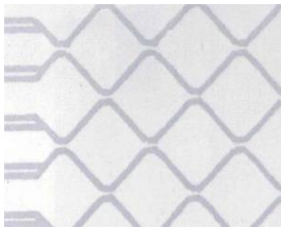
膜片上的ITO薄膜 線幅： 30\mu\text{m}
