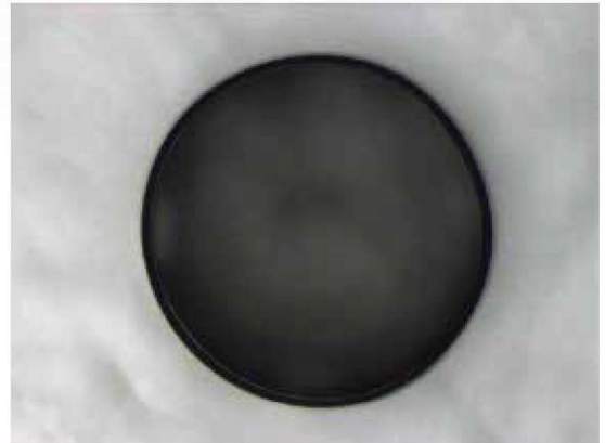
▲孔徑：0.2mm 錐刀：5 \mu m 材質：PET
