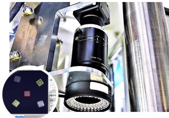
自動検査装置・アライメント装置
