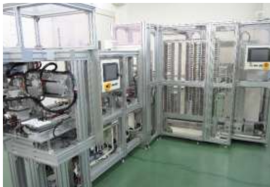
自動組立設備や自動搬送 製品の組立、搬送、バッファ設備
