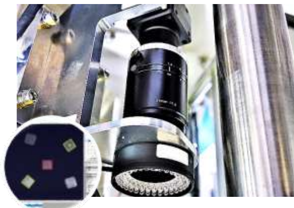
外観検査装置・アライメント装置 画像を使った検査や広角画像連結、 位置決め設備
