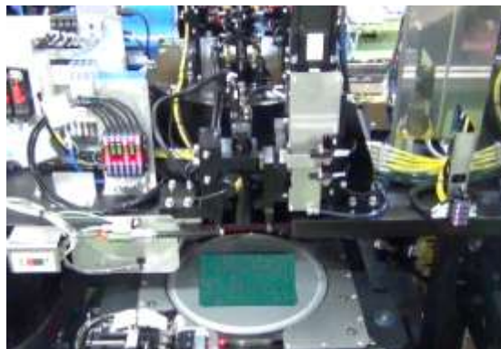
半導体関連の自動組立設備 チップ位置決めと搭載設備
