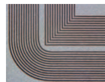
金属ペースト 加工幅：30 \mu m
