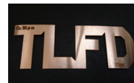
銅箔切断 厚み：50 \mu m
