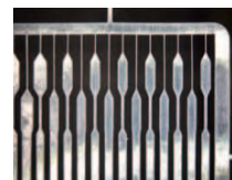
部分拡大 細線部幅：100 \mu m
