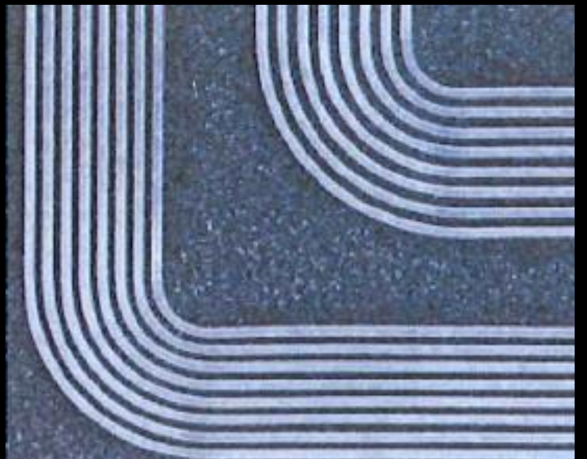
銀ペーストパターニング 除去幅 25 \mu m
