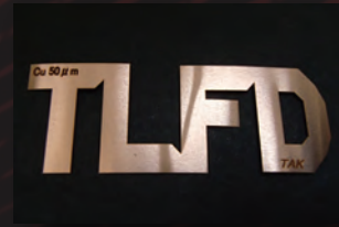
金属箔切断 銅 厚み 50 \mu m
