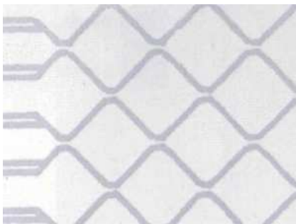
フィルム上のITO薄膜 ライン幅:30 \mu\text{m}
