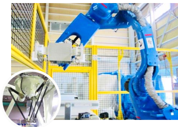
ロボット設備 ワーク供給、自動収納、段積み設備
