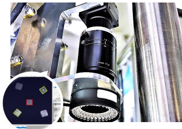
自動検査装置・アライメント装置 画像を使った自動検査やアライメント設備
