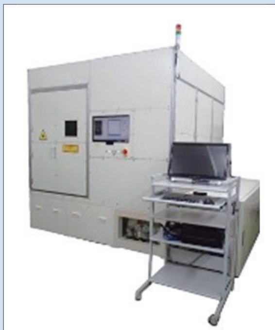
開発したレーザー切断装置の全景
